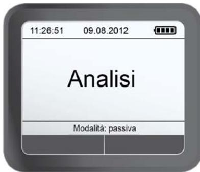
Durante la valutazione del campione di espirato, il LED giallo lampeggia. L'analisi può impiegare alcuni secondi in base alla concentrazione alcolica.
