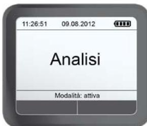
Il LED giallo lampeggia durante la valutazione del campione di espirato. L'analisi può impiegare alcuni secondi in base alla concentrazione alcolica. Al termine dell'analisi l'apparecchio emette un segnale acustico.
