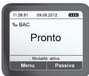
Dopo l'accensione l'apparecchio passa automaticamente alla modalità di misurazione attiva e sul display compare "Pronto".
