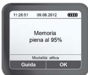
Il raggiungimento del 95% (9.499 misurazioni) della capacità di memoria viene segnalato sul display con il messaggio "Memoria piena al 95%".
