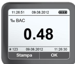
Visualizzazione della data di misurazione e del tasso alcolico.
