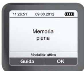
Dopo la 9.999 esima misurazione sul display appare il messaggio "Attenzione memoria piena". Alla misurazione successiva tramite un messaggio viene richiesto di sovrascrivere i dati precedenti. Confermare una volta selezionando >Sì< o >No<; quindi il messaggio viene visualizzato di nuovo solo all'accensione successiva.
